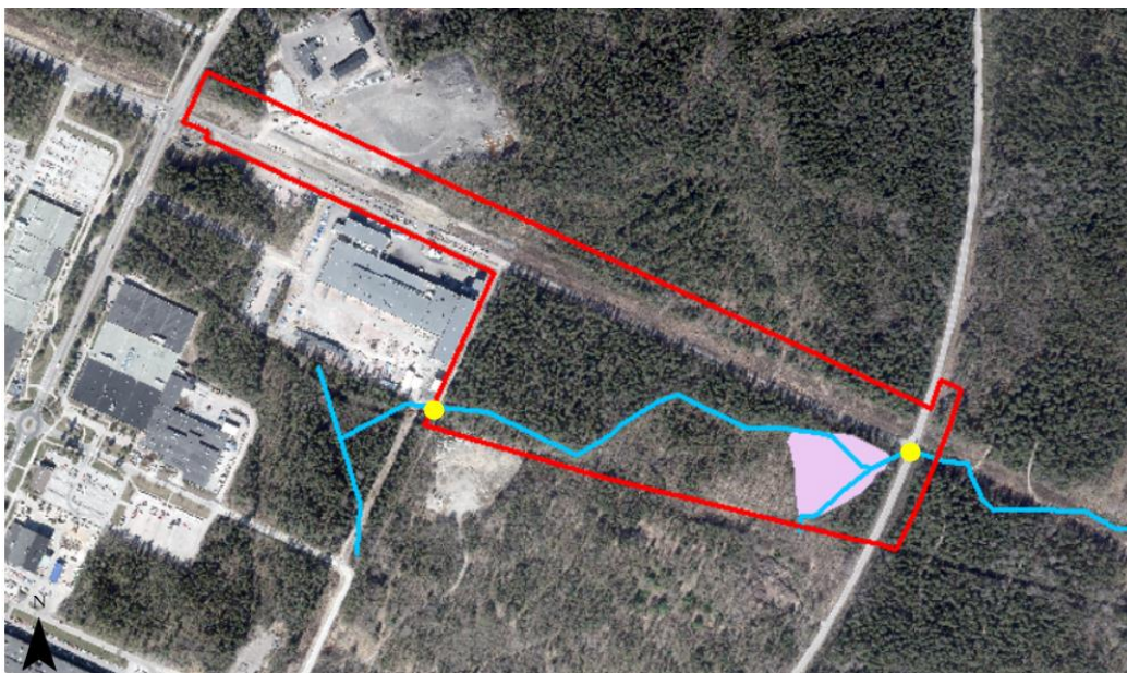
Figur 8. Befintligt dike (blå linje), placeringar av trummor (gula markeringar) samt utbredning av sumpskogen (rosa område).
