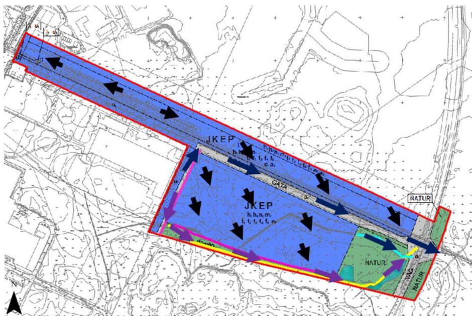
Figur 19. Förslag på sekundära avrinningsvägar vid skyfall (100-årsregn) då det allmänna dagvattennätet går fullt.
