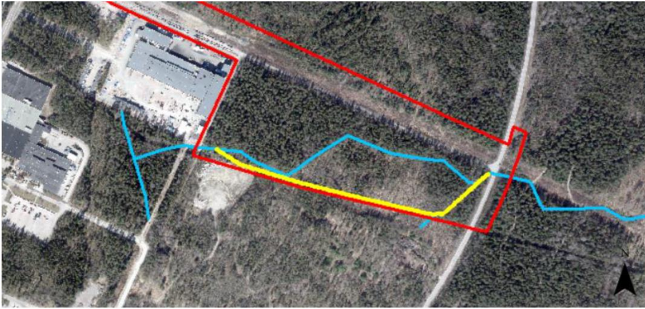
Figur 16. Förslag på ny sträckning av diket. Blå linje visar nuvarande sträckning och gul linje visar föreslagen sträckning.
