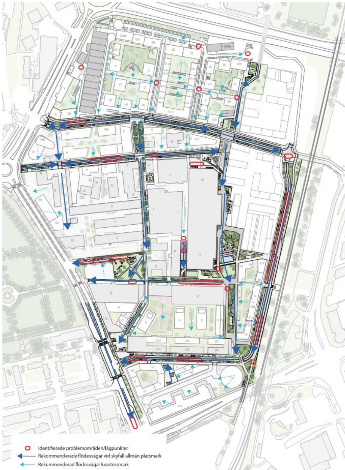
Figur 3. Figur som redovisar rekommenderade flödesvägar, som beror av planens höjsättning, vid skyfall för allmän platsmark (mörkblåa pilar) respektive kvartersmark (ljusblåa pilar). De röda ringarna redovisar identifierade problemområden/lågpunkter (Sweco, 2020d).
