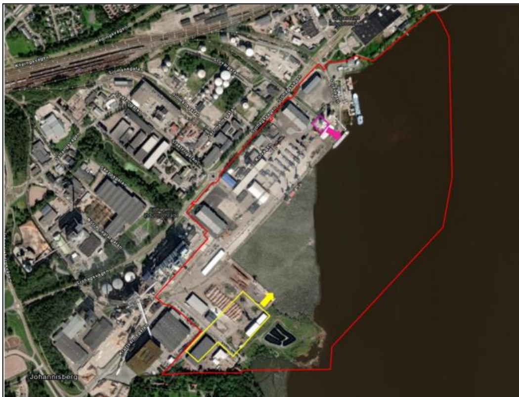
Figur 7.13 Översiktligt förslag till sekundär avrinning inom utredningsområdet vid extrema regn (100-årsregn). Gult område omfattar nya siloverksamheten och rosa område Kapellbäckendammarna (Sweco, 2023).
