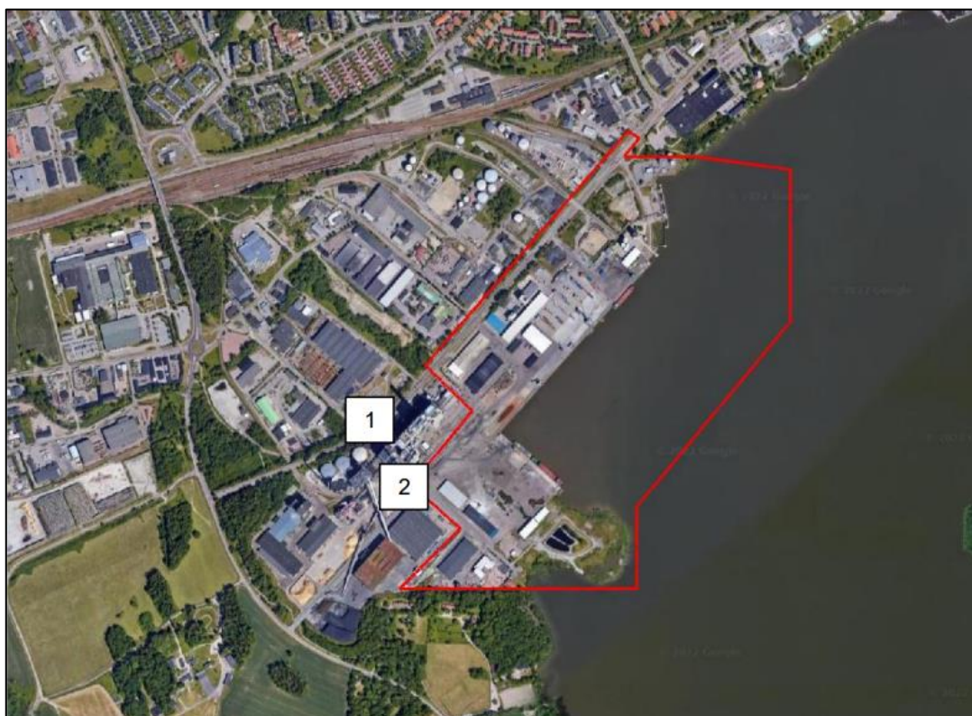
Figur 7.12 Punkter där olyckor på identifierade riskkällor kan leda till dominoeffekter av andra närliggande riskkällor. Sjöhagsvägens närhet till kraftvärmeverket (30 meter)(1) samt Kraftvärmegatan samt järnvägsspår invid kraftvärmeverket (kortaste avståndet 10 meter)(2) (Firetech Engineering AB, 2023).
