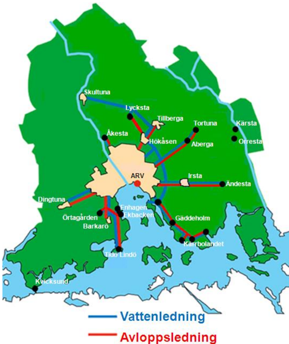
Figur 2: Bilden visar översiktligt ledningsnätet för vatten (blått) och avlopp (rött) utanför Västerås tätort.
