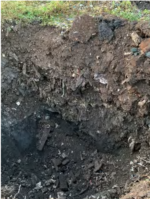
Figur 6.2 Foto över material från provgrop 7:27, exempel på förekomst av byggavfall i utfyllnadsområdet.
