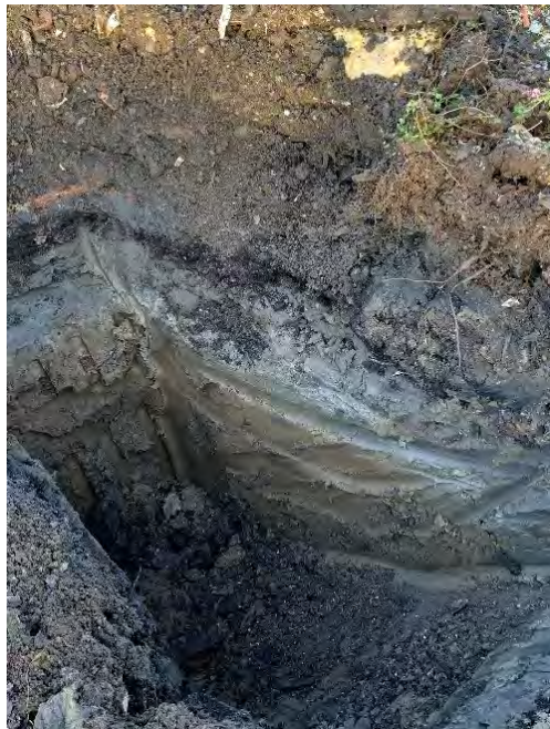
Figur 4.3 Bild från provgrop i delområde 3 (ursprung provpunktområde 5). Dessa provgropar hade alla ett tunnare svart skikt ovan lera enligt bilden.
