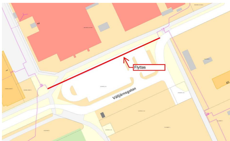
Bild 27. Fjärrvärmeledningen söder om Martinprocessen som behöver flyttas.
