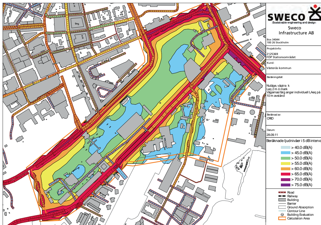
Figur 6.3. Illustration över bullerkartläggning för vägtrafikbuller inom planområdet. Färgmarkeringarna motsvarar uppmätt buller 2 meter över mark, ju mörkare färg desto högre bullernivå. (Sweco Infrastructure AB)
