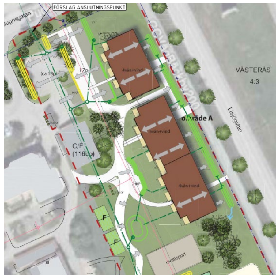
Förslag dagvattenhantering för planområdets norra del. Gult illustrerar diken/fördröjningsyta med ytavrinning från vägar och parkeringar. Grönt redovisar diken/fördröjning för omhändertagande av takavvattning, källa Sigma Civil AB.
