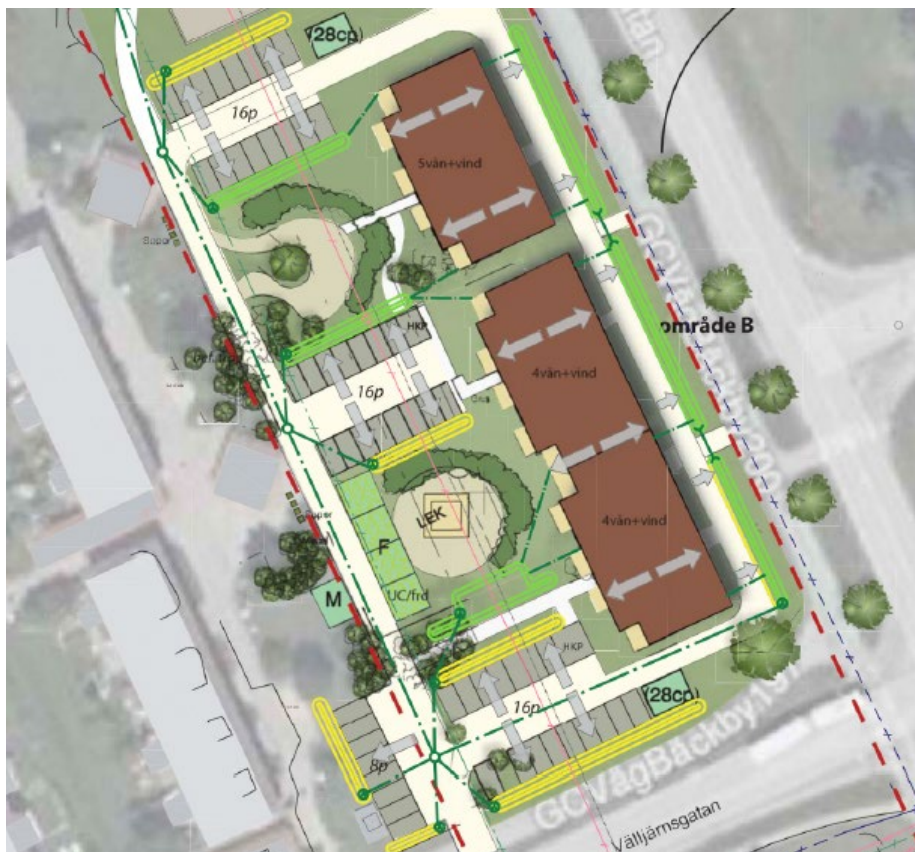
Förslag dagvattenhantering för den södra delen. Gult illustrerar diken/fördröjningsyta med ytavrinning från vägar och parkeringar. Grönt redovisar diken/fördröjning för omhändertagande av takavvattning, källa Sigma Civil AB.
