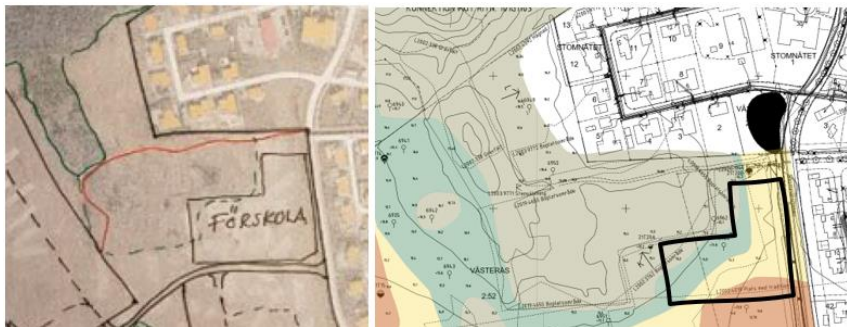
Figur 12. Vid planerad förskola bedöms lermäktigheterna variera mellan 0 – 8 m, enligt en tolkning från utförda undersökningspunkter. Till vänster i bild syns utdrag ur skissalternativ C och till höger utdrag ur planritning över tolkade lerdjupsmäktigheter 101G1203.
