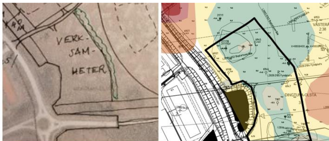
Figur 13. Vid planerat verksamhetsområde i sydväst bedöms lermäktigheterna variera mellan 0 – 4 m. Till vänster i bild syns utdrag ur skissalternativ C och till höger utdrag ur planritning över tolkade lerdjupsmäktigheter 101G1203.
