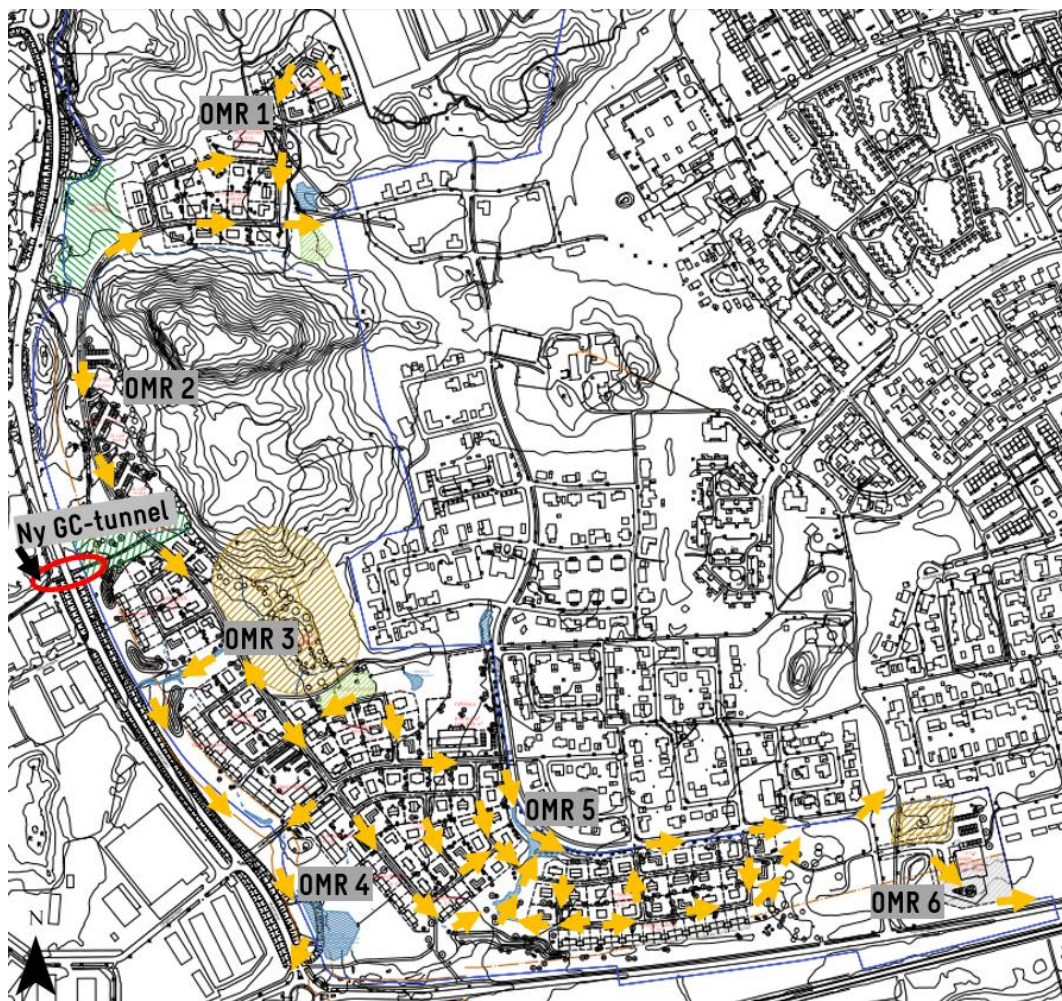
Figur 33. Förslag på sekundära avrinningsvägar vid skyfall (100-årsregn) då det allmänna dagvattennätet går fullt.
