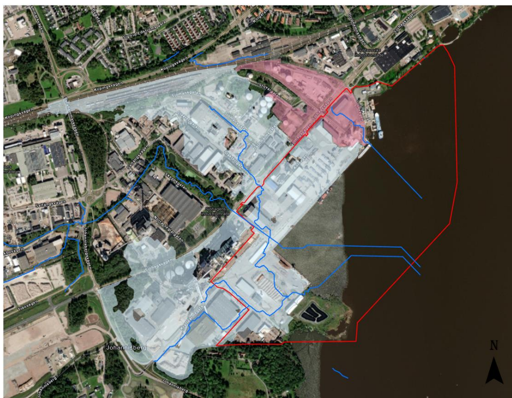
Figur 9. Avrinningsområden (blått och rosa område) inom planområdet. Blå linjer visar ytliga flödeslinjer vid extrema regn. (Scalgo, 2023)
