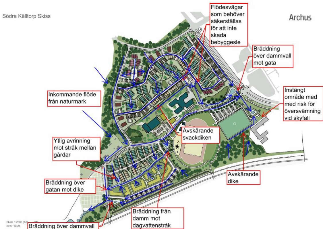
Figur 18. Ytliga flödesvägar som säkerställs vid skyfall för att inte riskera skador på bebyggelse inom planområdet. Från WSP (2016).
