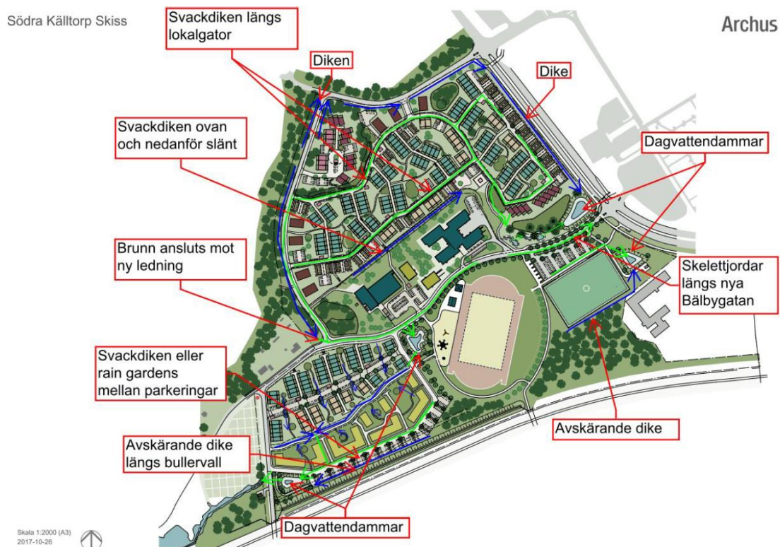
Figur 147. Föreslagen dagvattenhantering i planområdet. Blå linjer visar öppen avledning och gröna linjer visar ett grovt förslag på nya dagvattenledningar (från WSP, 2016).
